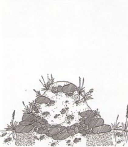
Stos suchy z kamienia naturalnego (rys. Dirk Lischewski)
